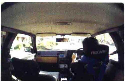
ドライブしている様子がわかるようにリアウインドウに取り付けた場合、かなりの広角レンズなので、横窓の画像も確認できる。映像の自動露出調整が室内に会うので外の映像は若干明るくなりますが、十分に認識できるレベル
