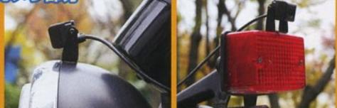
カメラ部分のコードはかなり長い為、大排気量のクレーマーモデルでも十分余裕のある配線レイアウトが可能。しかも完全防水の為、風雨が直撃する部分でも気にせず装着する事が可能だ。160°の超広角レンズの為、取り付け場所の工夫次第ではかなり面白。動画は撮影できると。
