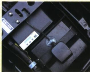
← 本体サイズは120×80×25mmで、入力電圧は12V/36Vに対応している。その隣にある一回り小さな黒い箱がGPSモジュールだ。
