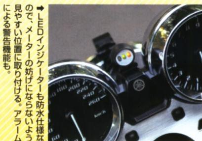
→ LEDインジケータも防水仕様なので、メーターの妨げにならないよう見やすい位置に取り付ける。アラームによる警告機能も。
